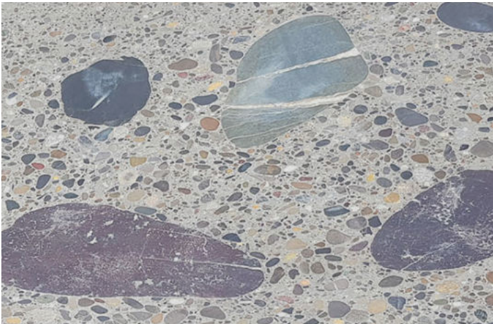
Konglomeratbeton gro- be Körnung auf halbes Korn geschliffen
