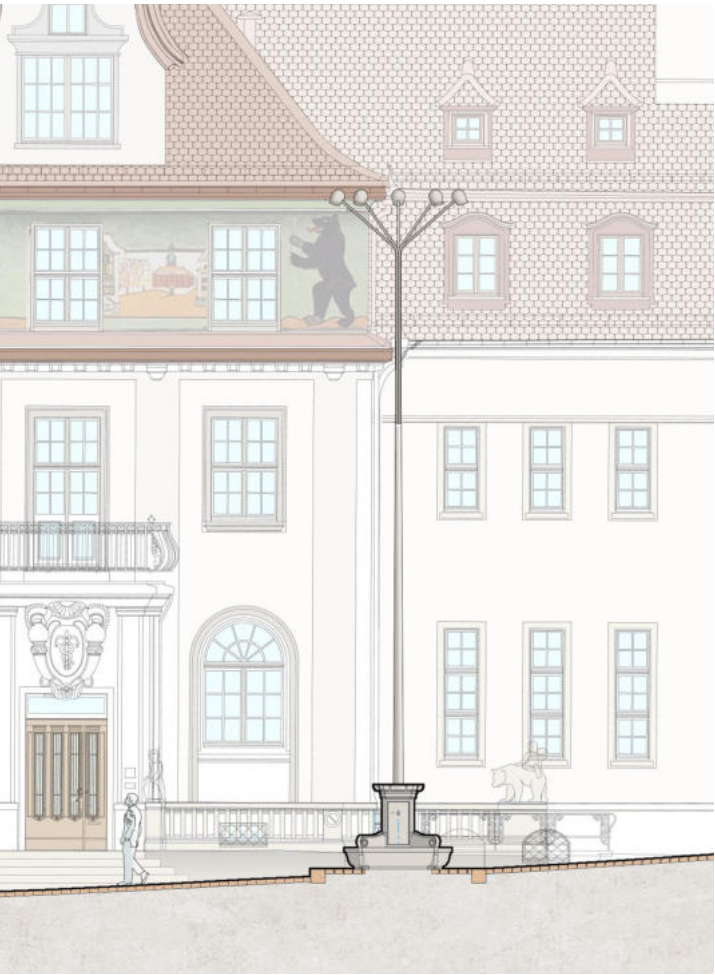
Schnittansicht Brunnen bestehend mit mehrmögiger Beleuch- tung
